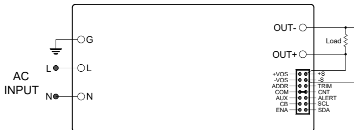
图6. ACB09单机应用接线图(遥测功能负载端连接)
