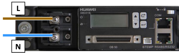
图4-6 单相交流输入示意图
