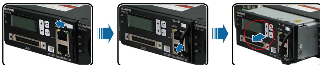
图5-3 拆卸监控模块
